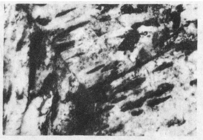
图5 CF304h样品的晶界碳化物偏析
